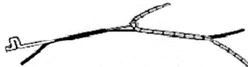
3. Avec l'oeil de l'aiguille saisir le deuxième câble. Le deuxième câble est tiré dans le premier câble. Introduire l'aiguille sur environ 10cm à partir de l'endroit d'où sort le premier câble, et le tirez sur environ 8cm vers l'extrémité du deuxième câble encore dehors. Introduire le premier câble dans l'oeil d'aiguille et tirez-le à l'intérieur du deuxième câble.
